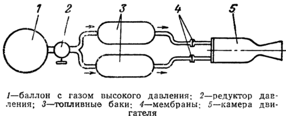
Рис. 1. Схема ВСП
