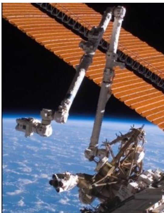
Рис. 1. Манипулятор SSRMS на подвижной платформе
