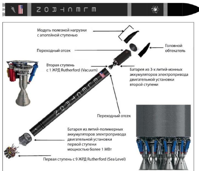
Рис. 4. Конструкция РН Electron компании Rocket Lab
