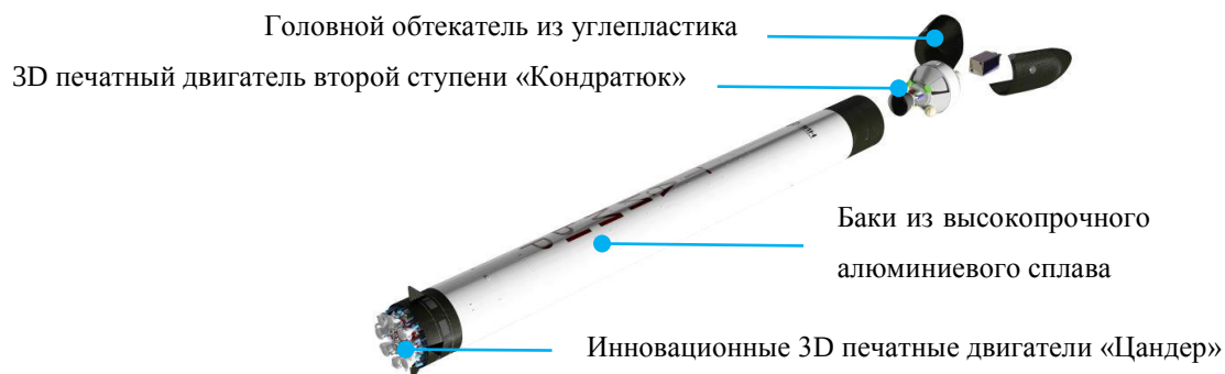
Рис. 6. Конструкция РН Таймыр компании «Лин Индастриал»
