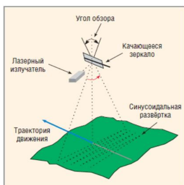
Рис. 3. Использование зеркала и лидара
