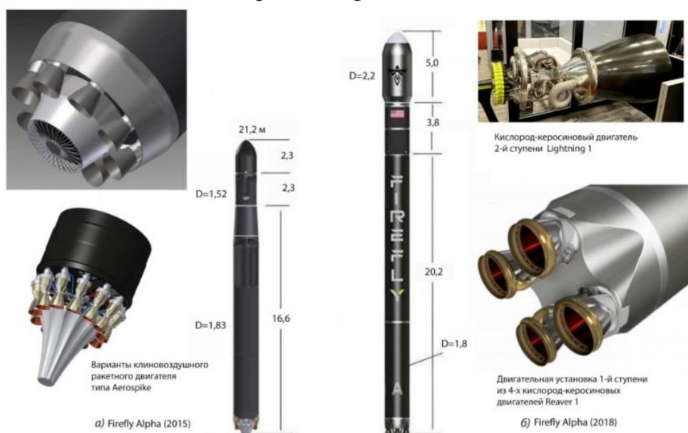
Рис. 3. Конструкция РН Alpha компании Firefly Aerospace
