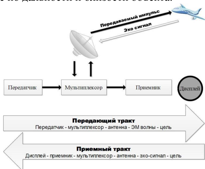
Рис. 1. Схема работы радара
