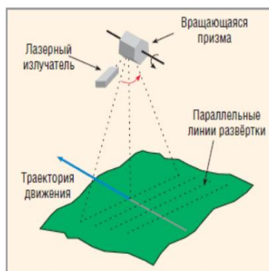
Рис. 4. Использование призмы и лидара
