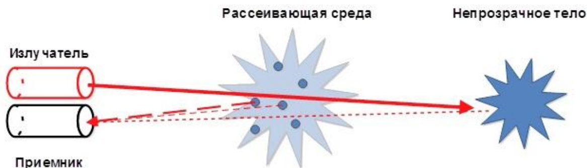
Рис. 2. Схема работы лидара
