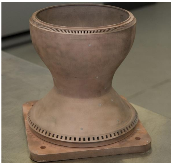
Рис. 2. Камера сгорания, выполнена с помощью SLM–технологии
