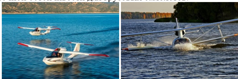
Рис. 1. а) гидропланы с поплавковой схемой «летающая лодка»; б) интегральная схема
