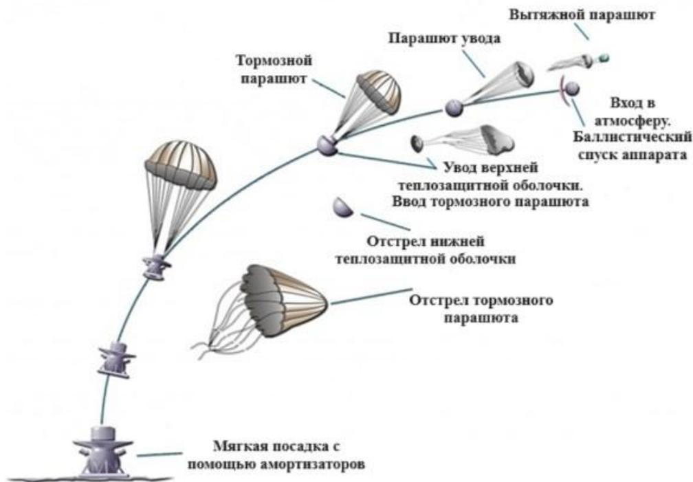
Рис. 1. Схема спуска на поверхность Венеры
