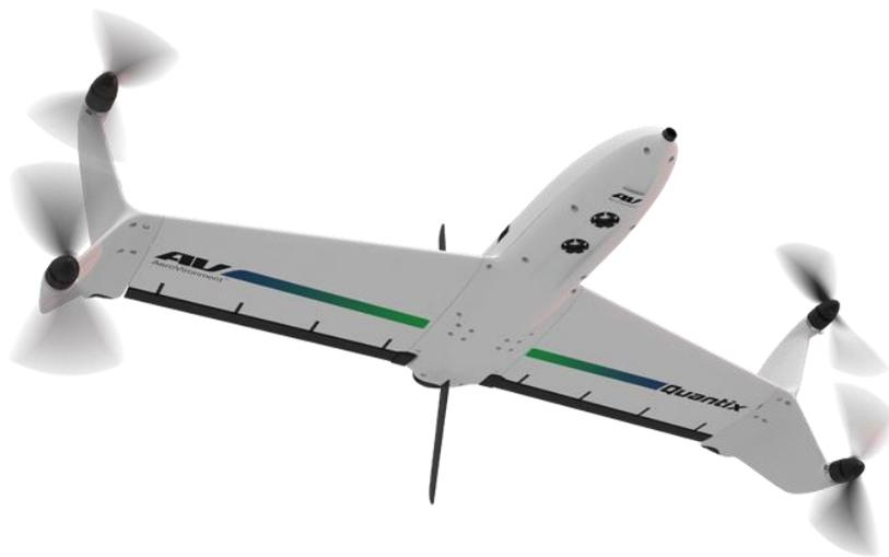
Рис. 2. БПЛА AeroVironment Quantix, использующий элероны и 4 винта
