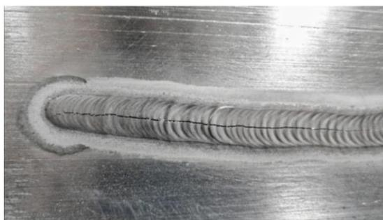
Рис. 4. Фото сварного шва с дефектом
