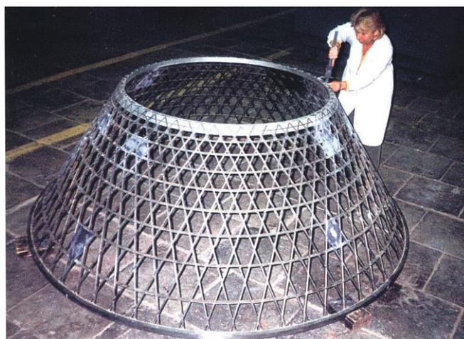
Рис. 5. Сетчатая оболочка из полимерных композиционных материалов ЦНИИ СМ
