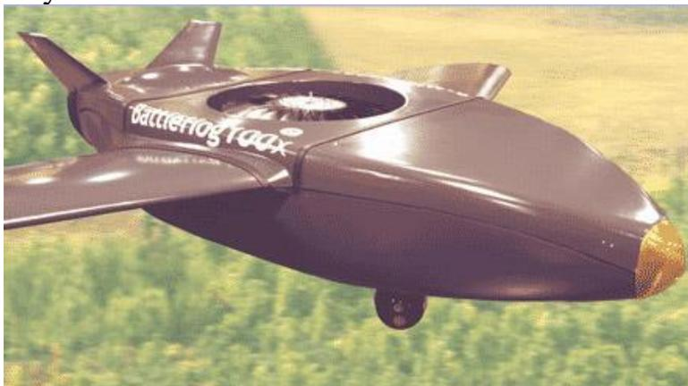
Рис. 2. Battlehog 100x, выполненный по схеме винтокрыл
