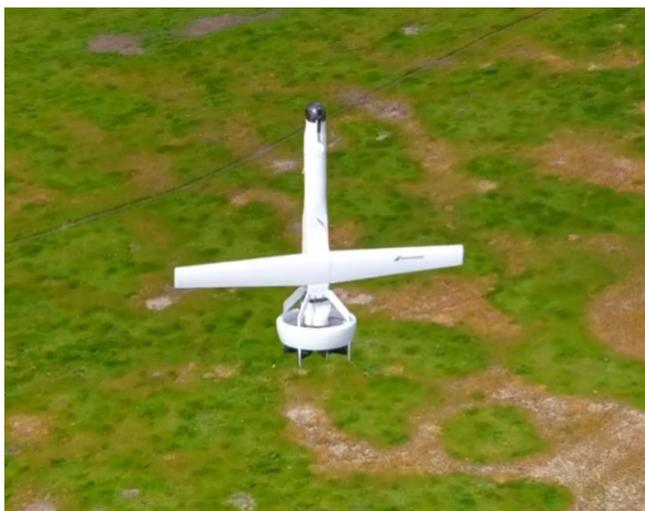
Рис. 1. V-Bat БПЛА-Tailsitter
