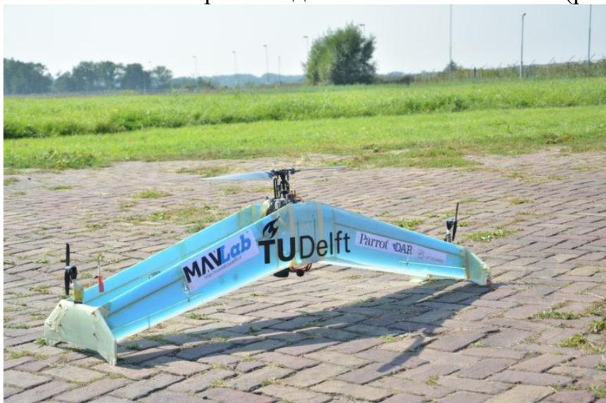
Рис. 3. БПЛА DELFTACOPTER с дополнительными винтами
