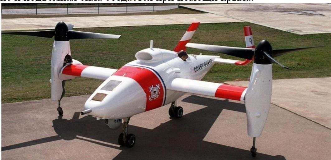
Рис. 4. Eagle Eye, выполненный по схеме конвертоплан
