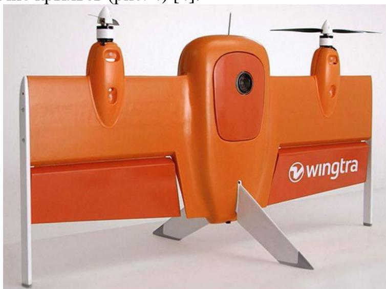
Рис. 4. БПЛА Wingtra
