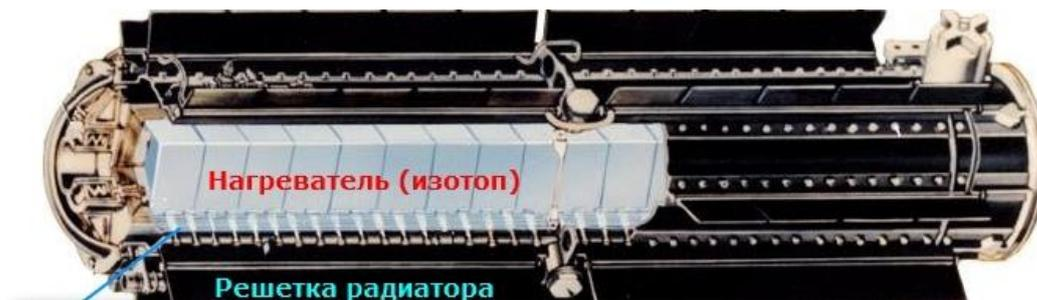
Рис. 1. Устройство РИТЭГ:
