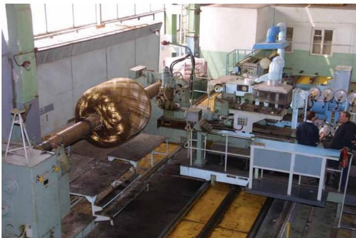
Рис. 4. Изготовление корпуса РДТТ из полимерных композиционных материалов методом намотки в КБ «Южное»
