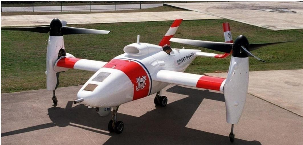
Рис. 4. Eagle Eye, выполненный по схеме конвертоплан
