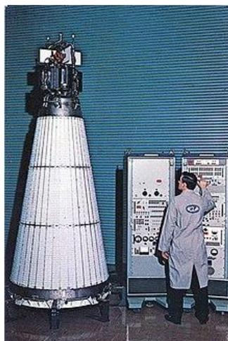
Рис. 2. Реактор космического назначения SNAP
