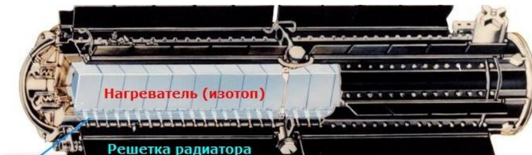
Рис. 1. Устройство РИТЭГ:
