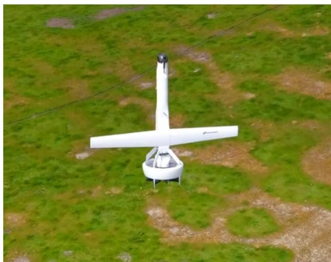
Рис. 1. V-Bat БПЛА-Tailsitter
