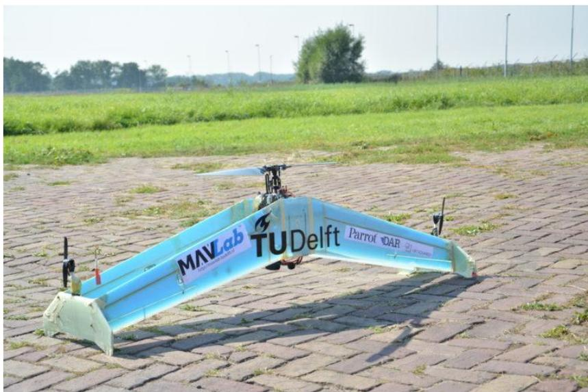
Рис. 3. БПЛА DELFTACOPTER с дополнительными винтами
