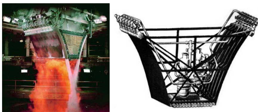
Рис. 2. Линейный воздушно-реактивный двигатель Rocketdyne RS-2200, двигатель Aerospike
